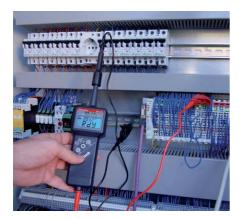
**Megohmmeter in Ex-areas** with EN 61557-2 (VDE 0413-2) Zuschaltbare Ableitprüfung nach EN 61340
